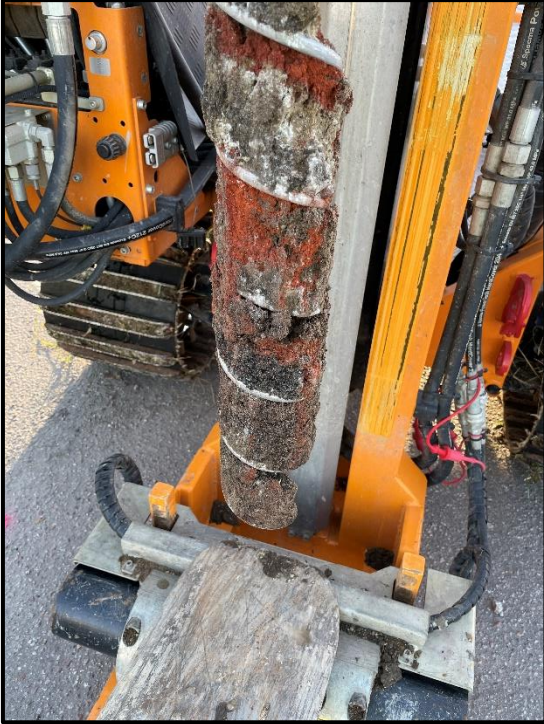
Figur 8. Fyllnadsmaterial med tegel och sten i provpunkt 21NC12, 0 – 0,5 m u m y
